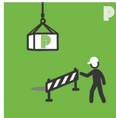
4. NE JAMAIS SE TROUVER SOUS UNE CHARGE SUSPENDUE
